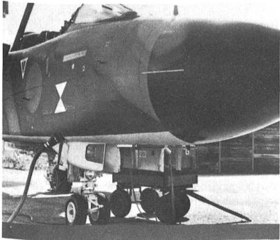
Der auf unserer Foto in einer meisselförmigen Verkleidung am vorderen Unterflügel eines Tornados integrierte Laserkopf des LRM TS ist im Bereich von  $+/- 90^\circ$  rollstabilisiert und hat einen Höhenrichtbereich von  $+3$  bis  $-20^\circ$  sowie einen Seitenrichtbereich von  $+/- 12^\circ$ . Für die Verwendung mit den Flugzeugtypen Jaguar, Harrier und Tornado baute Ferranti Ltd bis heute weit über 500 LRM TS-Anlagen. ka
