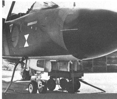
Der auf unserer Foto in einer meisselförmigen Verkleidung am vorderen Untertrumpe eines Tornados integrierte Laserkopf des LRM TS ist im Bereich von +/– 90° rollstabilisiert und hat einen Höhenrichtbereich von +3 bis –20° sowie einen Seitenrichtbereich von +/– 12°. Für die Verwendung mit den Flugzeugtypen Jaguar, Harrier und Tornado baute Ferranti Ltd bis heute weit über 500 LRM TS-Anlagen. ka
