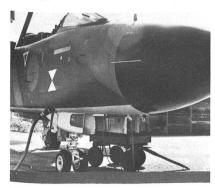
Der auf unserer Foto in einer meisselförmigen Verkleidung am vorderen Unterrumpf eines Tornados integrierte Laserkopf des LRMTS ist im Bereiche von +/- 90° rollstabilisiert und hat einen Höhenrichtbereich von +3 bis -20° sowie einen Seitenrichtbereich von +/-12°. Für die Verwendung mit den Flugzeugtypen Jaguar, Harrier und Tornado baute Ferranti Ltd bis heute weit über 500 LRMTS-Anlagen.
