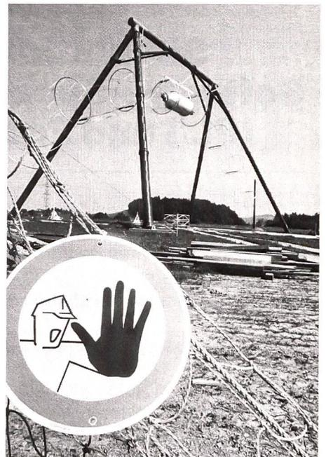
tromagnetischer Puls) entsteht bei jeder Atomexplosion und ist in der Lage, ungenügend geschützte elektrische und elektronische Einrichtungen zu zerstören. Mit Funksprüngen von 1,4 Mio Volt können mit der 26 Meter hohen Apparatur (Bild) Computer oder gar Lokomotiven auf ihre NEMP-Sicherheit hin überprüft werden. Keystone
