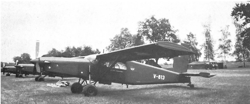
PC-6/B2-H2 Turbo Porter der leichten Fliegerstaffel 7 auf einem Feldflugplatz. Dank seiner hervorragenden Kurzstart- und -landeeigenschaften kann der PC-7 praktisch auf jeder grösseren Wiese starten und landen.
