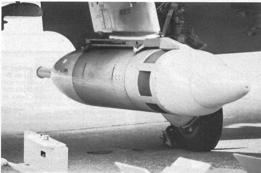
Zielschleppbehälter für Luft-Luft Schiessübungen an einem Hunter. Aus diesem Behälter wird auf Zielhöhe an einem dünnen Stahlseil ein Schleppsack ausgefahren, worauf dann geschossen wird.
