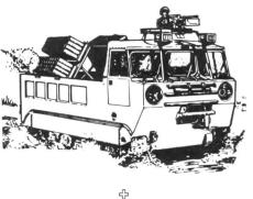
Anlässlich der Truppenübung «Lionheart» gelangte erstmals die für den Schutz mechanisierter Verbände ausgelegte Selbstfahrversion des Nahbereichs-Flugabwehrlenkwaffensystems Rapier im Rahmen von grösseren Manövern zum Einsatz. «Tracked Rapier» basiert auf einem stark modifizierten, leicht gepanzer-
