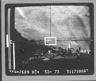
Skyguard, das miniaturisierte Allwetter-Feuerleitgerät, dient gleichzeitig der permanenten Luftraumüberwachung und der präzisen Steuerung von Mittelkaliber-Flabkanonen und Lenkwaffen. Es arbeitet weitgehend vollautomatisch und bildet einen wirksamen Schutz gegen angreifende Flugzeuge und Flugkörper.
