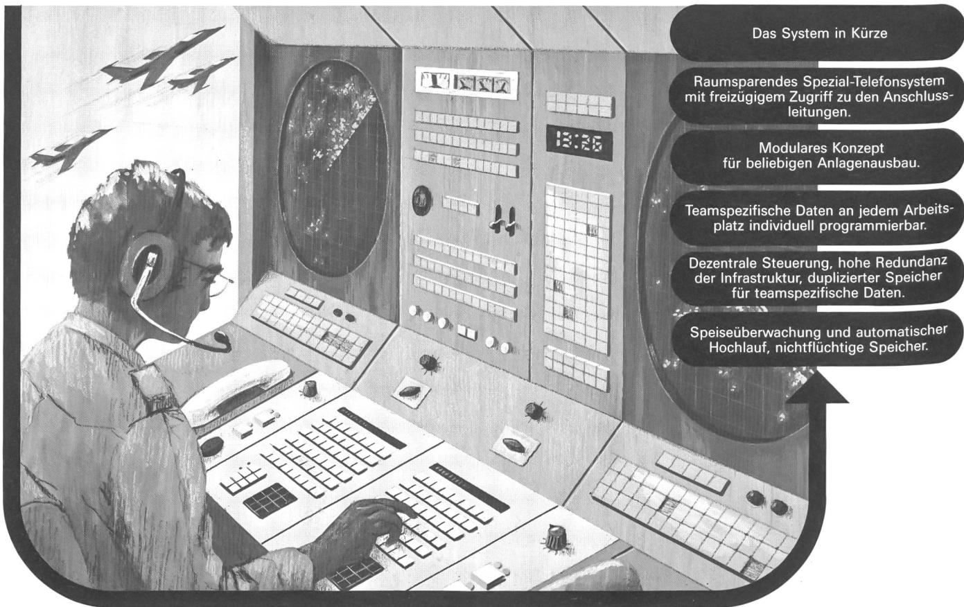
Das ALBIS ECS-M ist ein elektronisches, softwaregesteuertes Anschaltsystem für Telefon-Leitungen. Mit blossem Tastendruck stellt der Operator Verbindungen her, die er aus einer grossen Zahl von Stand- oder Wählleitungen auswählen kann. Die Tastatur ist programmierbar.
