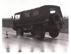
Vollbremsung bei 50 km/h.
