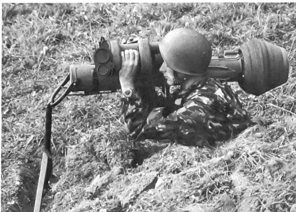
Panzerabwehrenkwaft «Dragon» (PAL BB 77). Einsatzdistanz 65–1000 m. Vo ca 80–100 m/Sek. Gewicht ca 11,5 kg, Länge ca 115 cm
