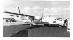
Basierend auf dem bewährten Mehrzwecktransportflugzeug F-27 Friendship schlägt die Herstellerfirma Fokker zwei neue Versionen für die luftgestützte Radarfrühwarnung und Mehrbetriebsarten-Aufklärung vor.
