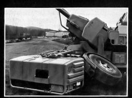
3D-Visier von Contraves: Automatische Zielvorrichtung, die alle Zieldaten ermittelt und zusammen mit  $v_0$ - und Meteowerten kontinuierlich die Vorhaltewerte errechnet.
