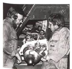
Einbau des Gasturbinen-Stromerzeugungsaggregats an de linken hinteren Kettenschulter des Schützenpanzers «Marder»
