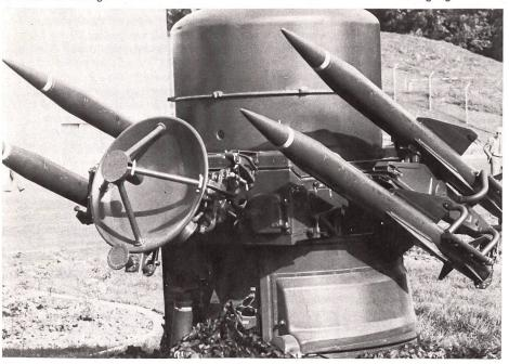
Der Lenkwaffenwerfer mit Suchradar (unter Radom), Gerät zur elektronischen Identifikation Freund-Feind (IFF), Kommandosender, Digitalrechner und vier Werferarmen zum Abschiessen von Kampflenkwaffen
