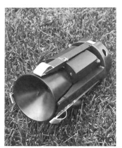
Für das mechanische Verlegen mit ua den Luft/Boden-Streuwaffensystemen «Mehrzweckwaffe 1», «Apache/CWS» (Container Weapon System), «MDS» (Modular Dispenser System) und «SOM» (Stand-Off Missile) entwickelt die Firma RTG GmbH, eine Tochtergesellschaft von MBB und Diehl, eine Lasso genannte autonome Panzerrichtmine. Der auf unserem Foto gezeigte Gefechtsfeldroboter liegt nach seiner Verbringung gefaltet in Lauerstellung. Die mit einem
