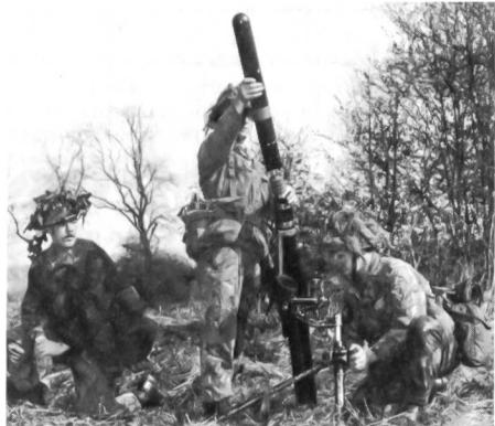
Das 900 mm lange und 6 Kilo schwere Geschoss kann von einem normalen Minenwerfer abgefeuert werden, nach dem Abschluss werden Stabilisatoren entfaltet, und der Gefechtskopf wird entsichert. Ein Millimeterwellen-Leitsystem führt das Geschoss ins Ziel, wobei nach dem Aufschalten des Sensors auf das Ziel im vorderen Teil der Granate kleine Flügel («Canards») entfaltet werden, die die Endphasenlenkung der Granate ins Ziel übernehmen.
