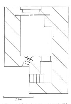
Abb. 2 Mg-Schartenstand, der meistgebaute Waffenstand, Limes Regelbau-Typ Nr 2 mit Panzerscharte.
