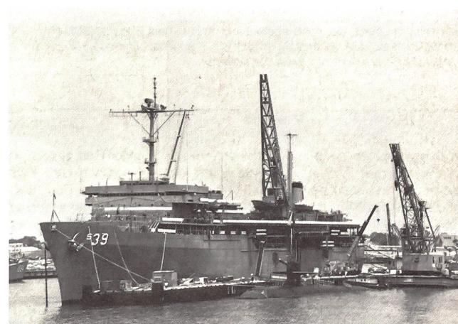
Am Pier 23 liegt das U-Boot-Mutterschiff USS L Y Spear (AS-39). Dieses 23 000-Tonnen-Schiff hat eine Besatzung von über 1300 Mann und dient vor allem als Dienstleistungsunternehmen, Munitionsdepot, Werkstatt, aber auch als geräumiger Aufenthaltsraum für eine Mehrzahl von U-Booten (in der Regel für die Schiffe einer «Squadron»).
