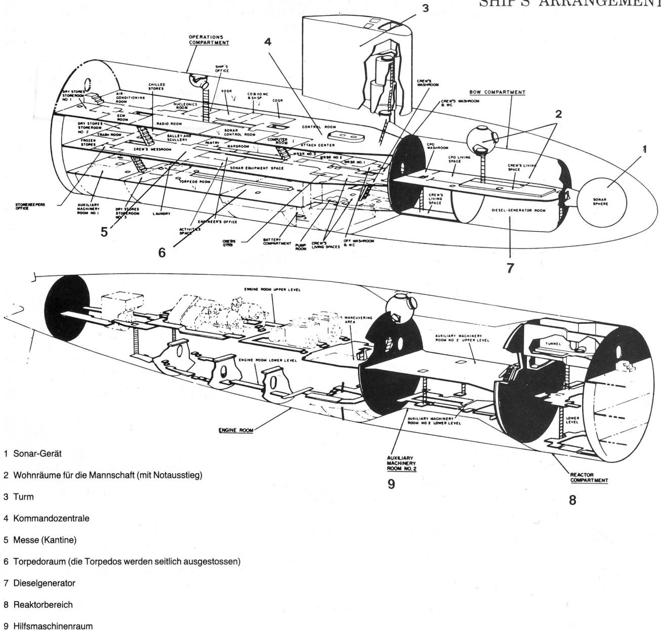
Längsschnitte durch das nukleargetriebene Jagd-U-Boot Finback (SSN-670), oben durch die vordere Sektion des Rumpfes inklusive Segel (Turm), darunter durch die Antriebsanlagen. Die Torpedolager und der Torpedoabschussraum befinden sich nicht in der Bugsektion, sondern mittschiffs, wo die Abschussrohre seitlich zur Längsrichtung des Bootes angewinkelt austreten.
