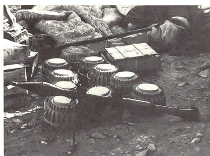
Chinesischer Nachbau der russischen Panzerfaust RPG-7 mit Klappvisier und Zweibeinstütze, kann auch mit Zielfernrohr ausgerüstet werden. Gewicht des Rohres: etwa 5 kg, Gewicht der Granate: etwa 2,5 kg, praktische Einsatzschussweite: 300 m, Panzerdurchschlag: etwa 300 mm. Dahinter chinesische Panzerminen und Munitionskisten.
