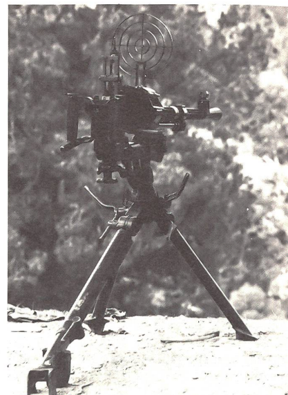
Chinesischer Nachbau des schweren Maschinengewehres SGM M-49 Gorjunow auf Dreibeinlafette, Kaliber 7,62 mm, Patrone M-08 (wesentlich stärker als M-43), Einsatzschussweite gegen Bodenziele: 1200 m, Kadenz: etwa 650 S/Min, Gewicht Mg: etwa 13,6 kg, Gewicht Dreibein: etwa 13,9 kg.
