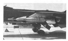
Basierend auf den beim Bau des Laserlenkrüstsatzes BGL für die Bestückung von 400-kg-Mehrzweckbomben gewonnen Erfahrungen entwickelte Matra in Zusammenarbeit mit SAMP eine für die Hartzielbekämpfung optimierte 1000 kg schwere Laserlenkbombe. Die auf unserer Foto an der rumpfnahen linken Unterflügelstation eines Jaguar-Erdkämpfers befestigte
