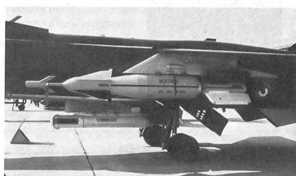
Basierend auf den beim Bau des Laserlenkrüstsatzes BGL für die Bestückung von 400-kg-Mehrzweckbomben gewonnenen Erfahrungen entwickelte Matra in Zusammenarbeit mit SAMP eine für die Hartzielbekämpfung optimierte 1000 kg schwere Laserlenkbombe. Die auf unserer Foto an der rumpfnahen linken Unterflügelstation eines Jaguar-Erdkämpfers befestigte
