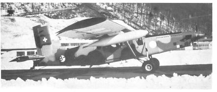
Pilatus PC-6/B2-H2 Turbo Porter auf dem Ablieferungsflug in den Nahen Osten. Unter dem Flügel erkennt man den 245 Liter fassenden Zusatztank, mit dem die Reichweite des Porters erheblich gesteigert werden kann. Der PC-6 kann an jedem Flügel insgesamt zwei Zusatztanks mitführen.
