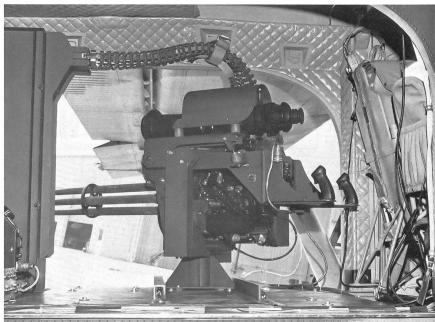
Fairchild Porter mit einer XM-197 Maschinenkanone und Infrarotnachtsichtgerät.
