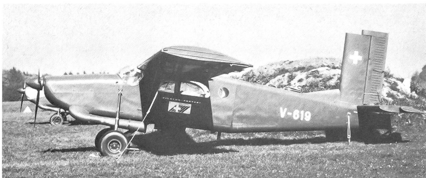
PC-6-H 2M Porter der Flugwaffe, ausgerüstet mit einem Kolbenmotor. 1980 wurden diese 12 Porter auf den Turbo-Porter-Standard gebracht.
