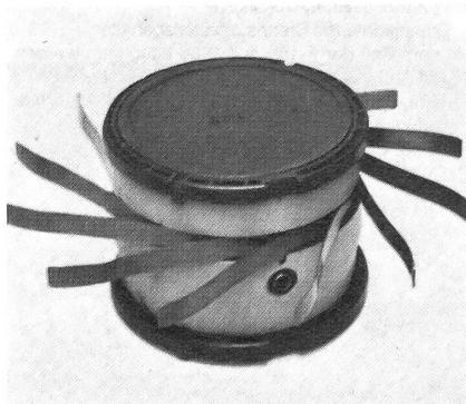
Der Ausstoss dieser Submunitionstypen, die wahlweise auch kombiniert mitgeführt werden können, erfolgt rückstossfrei nach beiden Seiten mittels Treibladungen. Die Belegung der Zielfläche wird über Ausstossintervalle und Ausstossgeschwindigkeit gesteuert. In der folgenden Ausgabe von ADLG werden wir noch die Submunitionstypen STABO und MUSPA besprechen, deren Entwicklung erst im kommenden Jahr abgeschlossen wird. ka
