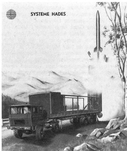
Die obige Abbildung zeigt eine mögliche Konfiguration der Boden/Boden-Lenkwanne Hades, wie sie von Aerospatiale als Ersatz für die taktische Artillerierakete Pluton zurzeit für die französischen Streitkräfte entwickelt wird. Hades unterscheidet sich von ihrem Vorgänger ua durch eine auf 360 km (Pluton: 120 km) gesteigerte Reichweite und möglicherweise einem Neutronengefechtskopf. Der auf unserem Illustratordbild ge-
