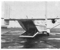
rund 20 Einsatzstützpunkte in Europa anfliegen. Ausgangspunkte dieser Nachschuboperation werden die Luftbasen Zweibrücken in der BRD, RAF Kemble und Torrejon in Spanien sein. Der mit je einer Frachttüre am Vorderrumpf und im Heck ausgerüstete Sherpa vermag bis zu vier Standardcontainer LD3 oder Triebwerke in der Grösse der Turbinen Pratt & Whitney Floo aufnehmen. Für ein rationelles Be- und Entladen wird der Sherpa überdies ein besonderes, ausbaubares Convoyer-System erhalten.
