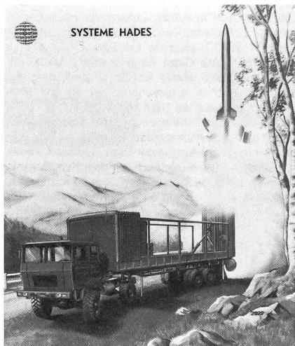
Die obige Abbildung zeigt eine mögliche Konfiguration der Boden/Boden-Lenkwanne Hades, wie sie von Aerospatiale als Ersatz für die taktische Artillerierakete Pluton zurzeit für die französischen Streitkräfte entwickelt wird. Hades unterscheidet sich von ihrem Vorgänger ua durch eine auf 360 km (Pluton: 120 km) gesteigerte Reichweite und möglicherweise einem Neutronengefechtskopf. Der auf unserem Illustratorbild ge-
