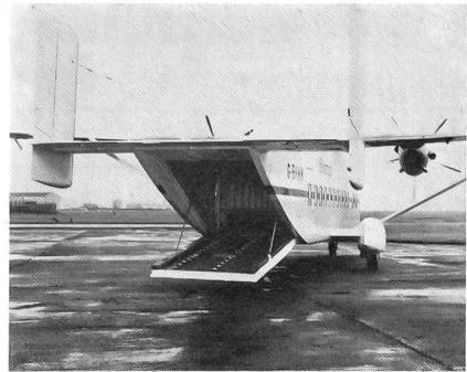
rund 20 Einsatzstützpunkte in Europa anfliegen. Ausgangspunkte dieser Nachschuboperation werden die Luftbasen Zweibrücken in der BRD, RAF Kemble und Torrejon in Spanien sein. Der mit je einer Frachttür am Vorderrumpf und im Heck ausgerüstete Sherpa vermag bis zu vier Standardcontainer LD3 oder Triebwerke in der Größe der Turbinen Pratt & Whitney Flo aufzunehmen. Für ein rationelles Be- und Entladen wird der Sherpa überdies ein besonderes, ausbaubares Convoyer-System erhalten. ka
