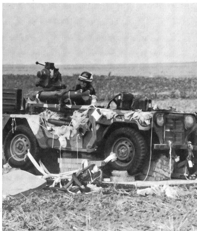
Zur Bewaffnung der 82. Luftlandedivision gehören auch auf Jeeps montierte Panzerabwehrkanonen des Typs «Tow». Hier entledigen Fallschirmjäger einen per Fallschirm abgeworfenen «Tow»-Jeep von seinen Polstern anlässlich einer Übung in der Bundesrepublik Deutschland 1982.
