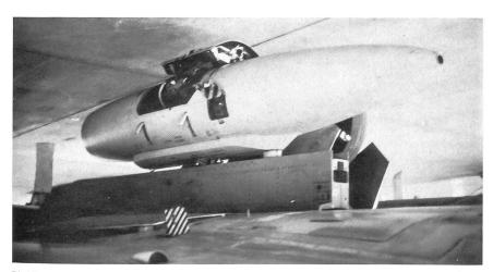
Die Mirage IIIRS des UeG können alle mit dem modernen Aufklärungsbehälter «Red Baron» der schwedischen Firma FFV ausgerüstet werden. Dieser Behälter beinhaltet das hochmoderne Zeilenabtastgerät RS-730 von Texas Instruments, mit dem Infrarotaufnahmen bei Tag und Nacht gemacht werden können.
