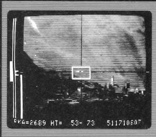
Das Feuerleitsystem Skyguard erfasst, verfolgt und bekämpft selbst schnellste und wendigste Tiefflieger. Bei kurzzeitiger Verdeckung des Ziels durch Bäume, Häuser oder Hügel übernimmt das Computer-Memory die präzise Nachsteuerung. Der Add On-Millimeterradar gewährleistet auch bei extremen topografischen Verhältnissen eine optimale Zielverfolgung.
