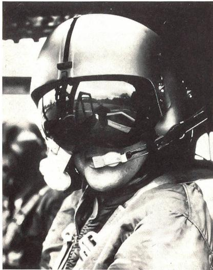
Für den Einsatz mit dem Waffensystem AH-64A Apache baut Honeywell das integrierte elektrooptische Helmsichtgerät IHADSS (Bild). Das «Integrated Helmet and Display Sighting System» offeriert dem Piloten die folgenden drei wichtigsten Betriebsarten:
