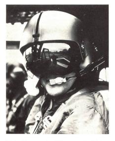
Für den Einsatz mit dem Waffensystem AH-64A Apache baut Honeywell das integrierte elektrooptische Helmsichtgerät IHADSS (Bild). Das «Integrated Helmet and Display Sighting System» offeriert dem Piloten die folgenden drei wichtigsten Betriebsarten:
