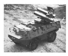
Für den Schutz von mobilen Einheiten vor im Tieffluge angreifenden Jagdbombern und Helikoptern schlägt Matra eine fahrzeuggestützte Version ihrer wärmeansteuernden Nahbereichsflugabwehrlenkwaffe SATCP (Systeme Sol-Air Très Courte Portée) vor. Als Fahrgestell für ein entsprechendes Musterfahrzeug wählte man den bei der französischen Armee im Dienste stehenden Radschützenpanzer VAB 4×4. Darauf aufgebaut ist ein Sechsfachwerfer SATCP zusammen mit einem Überwachungsradar (Wahlweise Rodeo 2 von
