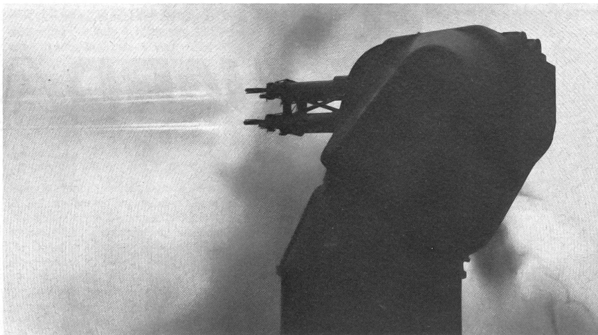
Automatische 25-mm-Vierlingskanone von Oerlikon-Bührle mit einer Gesamtschussfolge (zyklisch) von 3400/min.
