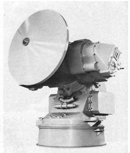
Vertikal polarisiertes Ku-Band-Zielfolgeradar von Siemens-Albis in Zürich.
