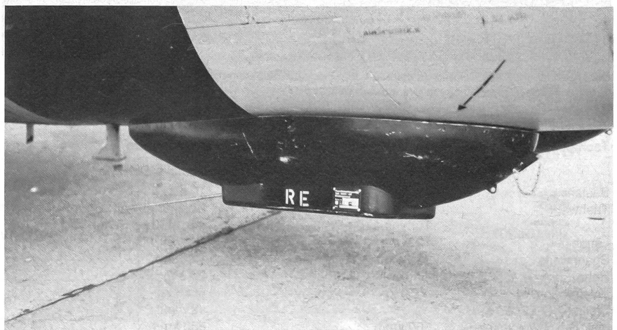
Düppelwerfer an einem Vampire Zielerstellungsflugzeug. Mit diesem Düppelwerfer werden jeweils die Skyguard. Feuerleitgeräte gestört, so kann realistisch die elektronische Kriegführung der Flab geübt werden.
