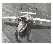
Basierend auf dem neuen Strahltrainer T-46A der USAF schlägt Fairchild eine für den Exportmarkt ausgelegte Version FRC-225 vor. Der von zwei Strahlturbinen Garrett F109-GA-100 angetriebane Hochdecker ist in der Lage, an bis zu vier Unterflügelstationen Waffen und Brennstoffzusatzbehälter im Gesamtge-
