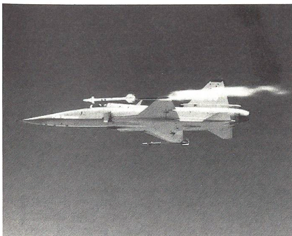
Das Waffensystem F-20 Tigershark schloss die erste Phase der Erprobung der Bordelektronik mit Erfolg ab. Die Tests umfassten 58 Flüge mit über 60 Flugstunden, wobei an einem Tag zwölf Luftkampfmissionen
