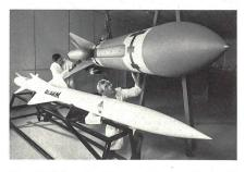
Diese Modelle voller Grösse geben einen Begriff von zwei der fortgeschrittensten Lenkwaffen der Welt, die im Rahmen von Programmen der British Aerospace entwickelt werden. Die «Sea Eagle» ist eine über dem Meer gleitende Luft-Schiff-Rakete, während die «Alarm» der Ausschaltung feindlicher Radargeräte dient. Beide Sysleme sind für die Royal Air Force bestimmt.
