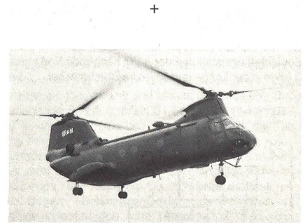
Boeing Vertol meldet den Erstflug eines kampfwertgeheiligsten Transporthubschraubers CH-46E Sea Knight der amerikanischen Marine und des Marinekorps. Das Modifikationspaket umfasst 26 Verbesserungen im Bereich Flugsicherheit, Einsatzzuverlässigkeit und Wartbarkeit mit dem Ziele, die Flugtüchtigkeit dieses Drehflüglers bis weit in die neunziger Jahre hinein sicherzustellen. Vorerst sollen vier Musterflugzeuge für die Piloteneinweisung gefertigt werden. Der Zulauf von 341 entsprechend modifizierten Maschinen zur Truppe wird in den Jahren 1985-1990 erfolgen. Die wichtigsten Punkte des Kampfwertsteigerungsprogramms umfassen Verbesserungen am Flugkontroll- und Kraftübertragungssystem. ka
