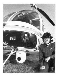
und einem turmlafettierten Unterrumpf-Vorwärtssicht-Infrarotsensor zusammen. Während des Fluges wird das einer Schwarzweiss-Fernsehaufnahme gleichender FLIR-Bild auf das Helmsichtgerät projeziert, so dass der Pilot die Umgebung ausserhalb des Cockpits wahrnehmen kann. Mit Hilfe seiner Kopfbewegung richtet er den FLIR-Sensor auf die Sichtlinie aus. Unsere Foto zeigt das Blickfelddarstellungsgerät am Helm des Piloten und den FLIR-Sensor an der Unterseite des Hubschraubers.
