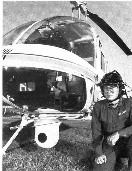
und einem turmlafettierten Unterrumpf-Vorwärtssicht-Infrarotsensor zusammen. Während des Fluges wird das einer Schwarzweiss-Fernsehaufnahme gleichen FLIR-Bild auf das Helmsichtgerät projiziert, so dass der Pilot die Umgebung außerhalb des Cockpits wahrnehmen kann. Mit Hilfe seiner Kopfbewegung richtet er den FLIR-Sensor auf die Sichtlinie aus. Unsere Foto zeigt das Blickfelddarstellungsgerät am Helm des Piloten und den FLIR-Sensor an der Unterseite des Hubschraubers. ka
