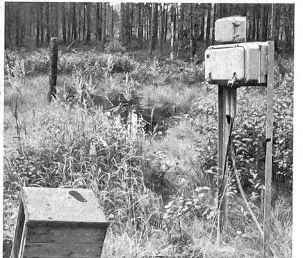
Zum Seismologischen Observatorium gehören auch eine Anzahl aussenstehender Stationen wie beispielsweise diese Schalldose für den kurzperiodischen Bohrloch-Erdbebenmesser.
