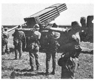
Bild oben: Ungelenkte Artillerieraketen vom Kaliber 12,2 cm. Feststoffantrieb. Splitterwir-kung oder C-Kampfstoff-Füllung. Beachte die Länge der Munition (Gewicht, Transportpro-blem).
