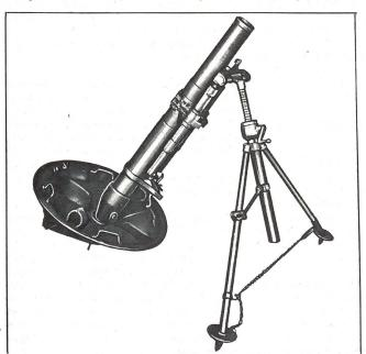
12 cm Minenwerfer. Gewicht in Feuerstellung 270 kg. Geschossgewicht 16 kg. Vo 272 m/ sek. Schussweite 5,5 km. Feuergeschwindigkeit 4–6 Schuss/min. Zum Werfer gehört eine pneubereifte Zweiradlafette. Zugfahrzeug: Lastwagen
