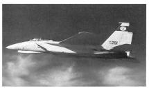
Zurzeit erprobt McDonnell Douglas eine F-15B Eagle die mit einem besonderen Behälter im Bereiche des Rumpfes unter dem Cockpit ausgerüstet ist. Der entsprechende Pod ist so ausgelegt, dass er eine Vielzahl von Sensoren aufnehmen könnte, wie sie zB von Aufklärungs- und Radarbekämpfungsflugzeugen mitgeführt werden.
