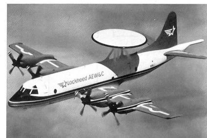
Die mit firmeneigenen Mitteln entwickelte Radarfrühwarn- und Jägerleitversion einer P-3 Orion absolviert gegenwärtig ein Flugerprobungsprogramm, bei welchem mit Schwergewicht das aerodynamische Verhalten
