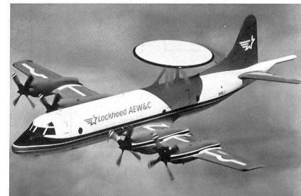
Die mit firmeneigenen Mitteln entwickelte Radarfrühwarn- und Jägerleitversion einer P-3 Orion absolviert gegenwärtig ein Flugerprobungsprogramm, bei welchem mit Schwergewicht das aerodynamische Verhalten
