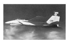
Zurzeit erprobt McDonnell Douglas eine F-15B Eagle, die mit einem besonderen Behälter im Bereiche des Rumpfes unter dem Cockpit ausgerüstet ist. Der entsprechende Pod ist so ausgelegt, dass er eine Vielzahl von Sensoren aufnehmen könnte, wie sie zB von Aufklärungs- und Radarbekämpfungsflugzeugen mitgeführt werden.
