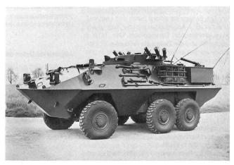
Piranha Panzerjäger 85 mit eingefahrener TOW 2 Säulenlafette. Der Vorteil dieser Ausführung besteht darin, dass das TOW 2 System während der Fahrt vor Feindbeschuss geschützt wird und nur für die Panzerbekämpfung ausgefahren werden braucht. Vor der «TOW 2 Kuppel» ist ebenfalls die 360° drehbare Kommandantenkuppel mit dem Periskop sichtbar.
