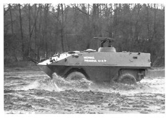
Piranha  $4\times4$  mit einem von der MOWAG entwickelten MG Turm bei voller Fahrt in schwerem Gelände
