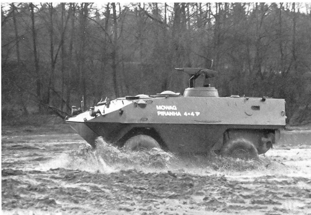
Piranha 4x4 mit einem von der MOWAG entwickelten MG Turm bei voller Fahrt in schwerem Gelände
