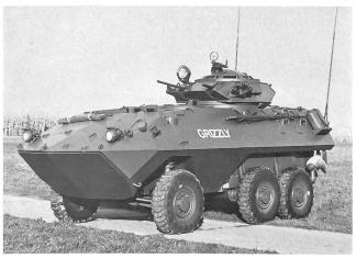
Piranha  $6\times 6$  «Grizzly» der kanadischen Streitkräfte. Am Heck sieht man deutlich einen der beiden Propeller, die dem Panzer im Wasser eine Geschwindigkeit von 10~km/h verleihen.
