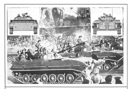
3 + 7 Mann Besatzung Abmessungen Länge 6.71 m 3,09 m Breite Höhe 2,06 m fährt (Strasse) Beweglichkeit 80 km/h schwimmt 10 km/h 35° steiat klettert 0,70 m überschreitet 2.50 m
