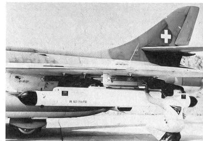
Mit der Behälterversion des Selbstschutz-Störsenders AN/ALQ-171(V) von Northrop fanden Tragversuche an Bord eines Hunters der Schweizer Flugwaffe statt. Für die Energieversorgung des Mehrbetriebsarten-Störsenders ist im Rumpfbug der Gondel eine Stau luftturbine integriert. Bekanntlich beteiligt sich die Schweiz an der Entwicklung der u.a. für die Ausrüstung der F-5E/F Tiger bestimmten rumpfkonformen Ausführung des Systems AN/ALQ-171(V). ka
