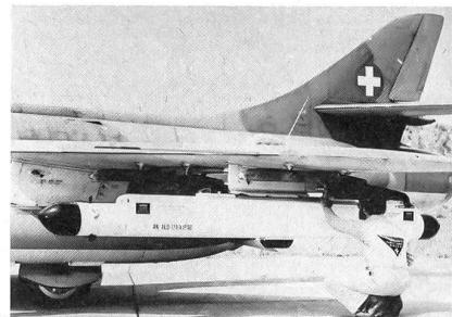
Mit der Behälterversion des Selbstschutz-Störsenders AN/ALQ-171(V) von Northrop fanden Tragversuche an Bord eines Hunters der Schweizer Flugwaffe statt. Für die Energieversorgung des Mehrbetriebsarten-Störsenders ist im Rumpfbug der Gondel eine Stauflutturbine integriert. Bekanntlich beteiligt sich die Schweiz an der Entwicklung der u.a. für die Ausrüstung der F-5E/F Tiger bestimmten rumpfkonformen Ausführung des Systems AN/ALQ-171(V). ka
