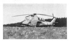
schrauber HAC 3G (Hélicoptère Antichars 3me Génération), ausgerüstet mit dem «Fire-and-Forget»-Waffensystem PARS-3 (Panzerabwehrraketensystem der 3. Generation) und einem Mastvisier
