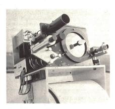
Auch dies ist ein wichtiges Element zur supergenauen Ermittlung: der sogenannte Lasertracker (Tracker = Aufspürer, Verfolger) dient zur Bestimmung der Position des Versuchsflugzeugs
