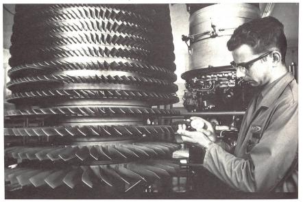
Kontrollarbeiten an Turbinenschaufeln eines Hunter-Triebwerkes.
