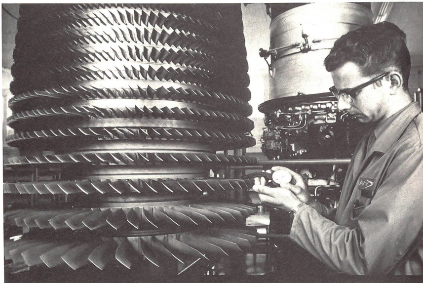
Kontrollarbeiten an Turbinenschaufeln eines Hunter-Triebwerkes.
