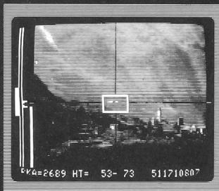
Das Feuerleitsystem Skyguard erfasst, verfolgt und bekämpft selbst schnellste und wendigste Tiefflieger. Bei kurzzeitiger Verdeckung des Ziels durch Bäume, Häuser oder Hügel übernimmt das Computer-Memory die präzise Nachsteuerung. Der Add On-Millimeterradar gewährt leistet auch bei extremen topografischen Verhältnissen eine optimale Zielverfolgung.
