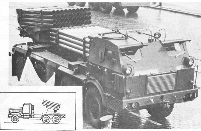
Mehrfach-Raketenwerfer BM-21 (Kaliber 12,2 cm, 40 Rohre)
