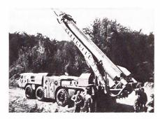
DDR-Volksarmisten bedienen eine Boden-Boden-Rakete vom Typ SCUD-B/MAZ-543 irgendwo in der DDR. Dieses Waffensystem ist eine einstufige Artillerie-Lenkrakete auf Selbstfahrlafette montiert.
