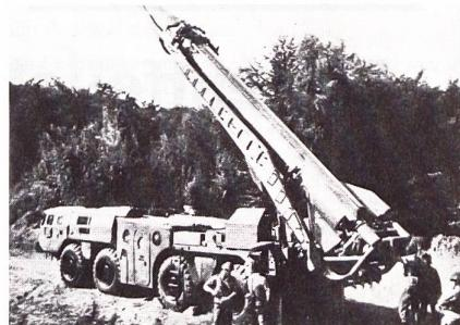
DDR-Volksarmisten bedienen eine Boden-Boden-Rakete vom Typ SCUD-B/MAZ-543 irgendwo in der DDR. Dieses Waffensystem ist eine einstufige Artillerie-Lenkrakete auf Selbstfahrlafette montiert. Der Abschluss der Rakete erfolgt senkrecht zur Erdoberfläche vom abgeklappten «Abschusstisch». Das Foto beweist, dass DDR-Einheiten zur Handhabung solcher RaketenSysteme ausgebildet sind und dass Erich Honeckers Armee über solche Waffen verfügt. OB
