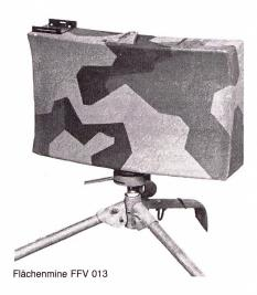
ders IRMAH: 80 m, Panzerdurchschlagsleistung bei senkrechtem Auftreffen des Projektils: auf 80 m 50 mm Stahl, auf 40 m 70 mm. Panzer-Richtminen eignen sich für den Einsatz in überbauten Gebieten, wo Minen nicht vergraben werden können, zum raschen Sperren von Engnissen oder zum Schliessen von Minengassen.
